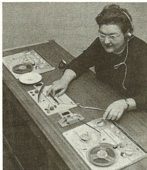
Sådan ser lærerpulten ud i Philips sproglaboratorium. Frk. G. Visby indtaler en lektie, som via båndoptageren til højre sendes til eleverne. På den anden båndoptager foretages kontroloptagelser af elevernes præstationer.
