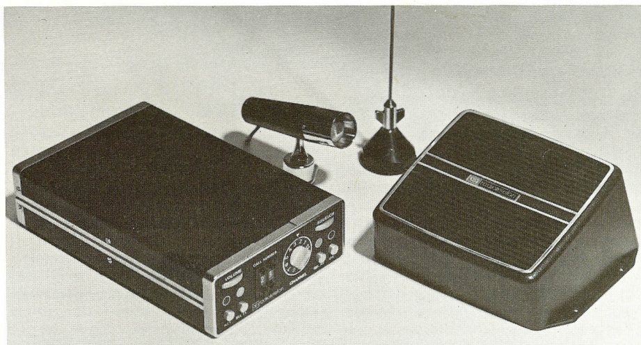
AP 2000 er en kombineret sender og modtager, der placeres under instrumentbrættet i bilerne.
