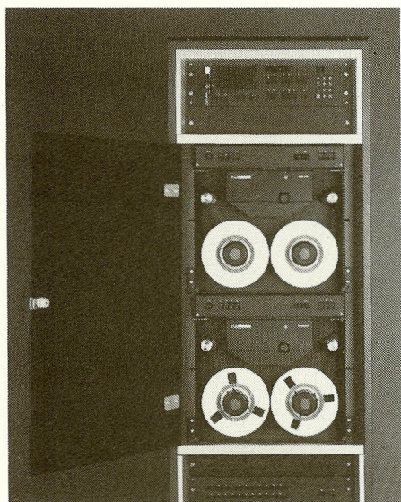
Kommunikations-båndoptager til kontinuerlig optagelse af indtil 44 samtidige telefon-samtaler – bl.a. solgt til brandvæsen, politi, banker og lufthavne.
