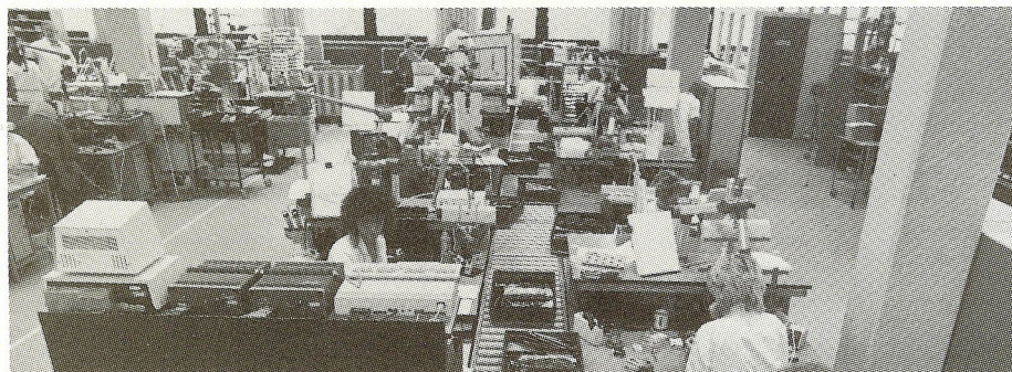
Et blik ned ad det nye produktionsbånd til Handset (telefonrør). Hver person tager en kasse ind og udfører det foreskrevne. På få timer er løsdelen blevet til et helt handset.
