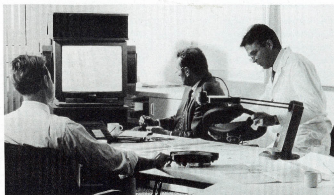
Philips' nye udstyr »TITAN junior« til videokonferencer kan bruges hvor som helst, der er adgang til lysnettet og til en ISDN-kommunikationslinje. Systemet tilpasser sig automatisk til akustikken i lokalet, så man undgår generende ekkovirkninger.
